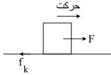
از طرف شخص به جعبه یک نیروی محرک  $F$  وارد می‌شود که چون  $F \geq f_k$  است  $f_k$  نیروی اصطکاک جنبشی وارد بر جسم از طرف سطح زمین است) جسم بر روی سطح می‌لغزد.
